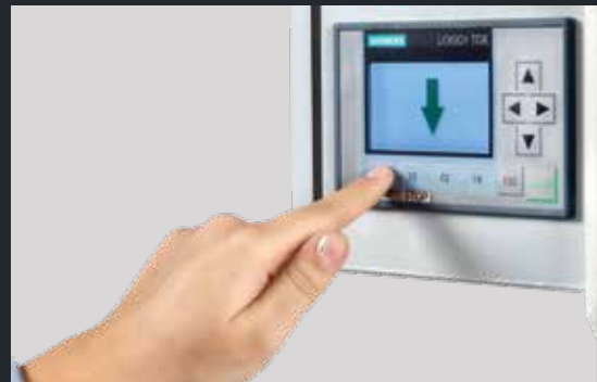
Einfache Bedienung der Siemens-Steuerung nach dem Befüllen, mit anschließender Ballenfertigmeldung
