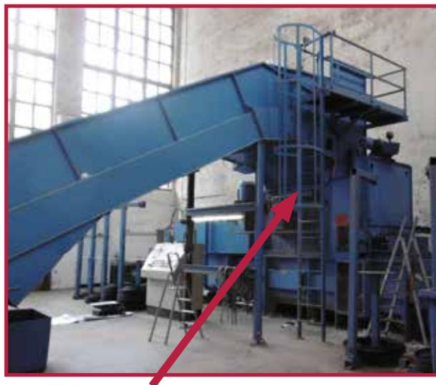
Zugangsbühne mit Not-Aus-Einrichtung, Abstiegsabsicherung und Leiter. Zugangsbühne auf Anfrage
