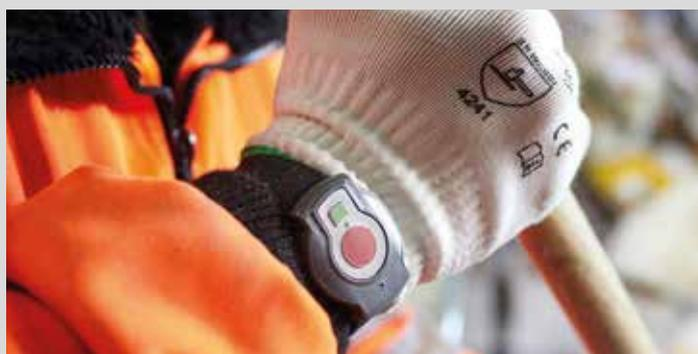
Aber das geht auch anders! Das auf modernster RFID-Technologie basierendes Personenschutzsystem von U-Tech ist ein elektronisches System, da in Verbindung mit einem am Körper getragenen Personenschutzmodul (PSM) die Abschaltung einer Maschineneinrichtung bewirkt, sobald Ihr Mitarbeiter in die Gefahrenzone eintritt.
