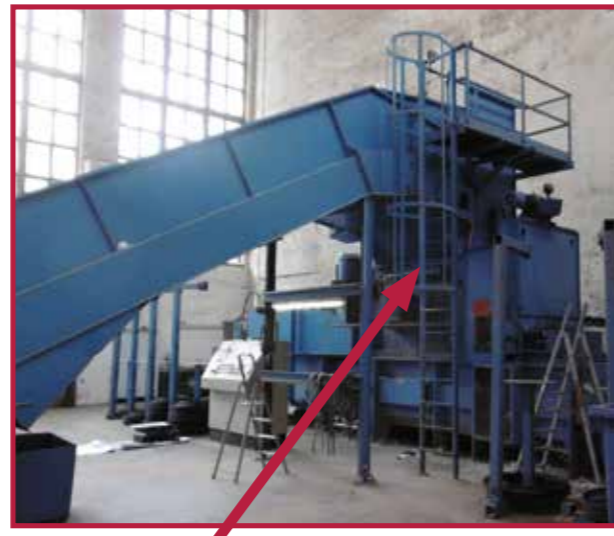
Zugangs­bühne mit Not-Aus-Einrichtung, Abstiegsabsicherung und Leiter. Zugangs­bühne auf Anfrage
